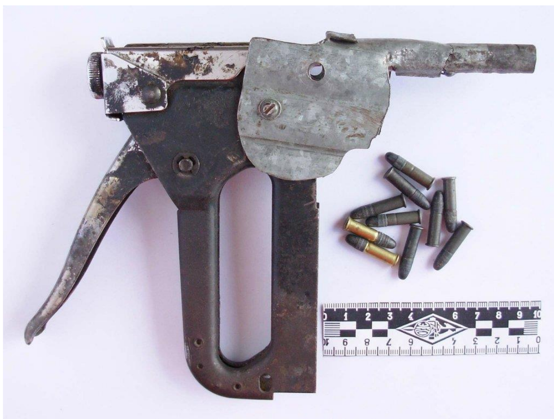
Pistola calibre .22 largo hechiza, creada con una engrapadora, decomisada en Brasil.
